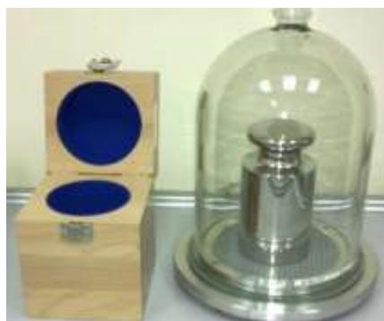
Цилиндрическая гиря 2 кг класса E2 в деревянном футляре
