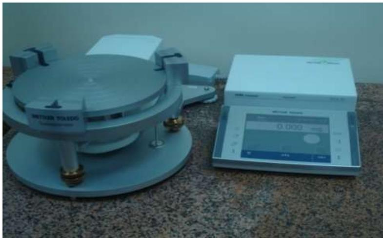
Компаратор Microbalance XP 6U, Магнитометр Susceptometer S-50
