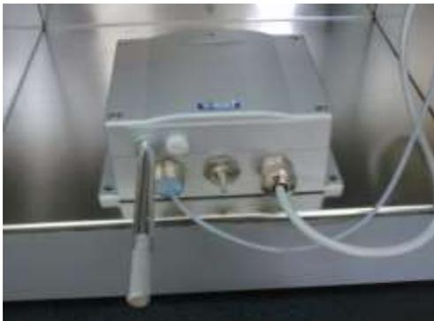
Передачик давления, относительной влажности воздуха и температуры
